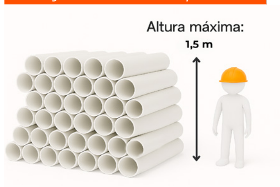
Imagen N°6 Altura máxima de apilamiento
